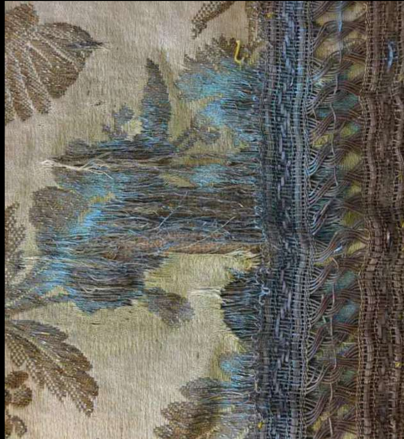
Oxidación de hilos de plata
